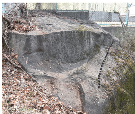
愛宕山の山裾、築城にともなう「石切場」岩に矢穴を彫り鉄のクサビを打ち込んで割る
